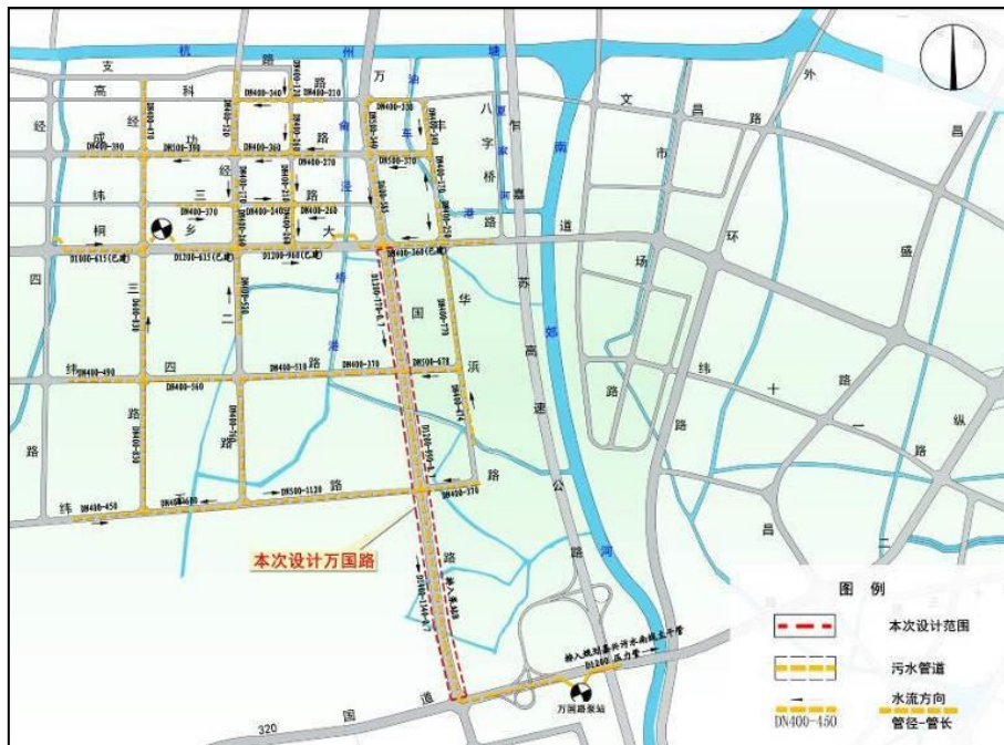
图 10 污水系统的构建
